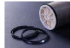
**终端插头 (DEP)** - 从容器一端卸下产水管时，终端插头可以用于密封另一端产水管的管口。可用于改造时上流膜元件与压力容器后盖之间有间隙的情况。
