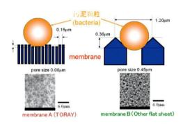
•‡• 拥有超过25年的研究和技术开发经验,东丽研发平板膜片由聚偏氟乙烯材料制造而成,平板膜片上拥有无数均匀0.08微米小孔。这种小孔的径膜结构能有效地抗堵塞,具有稳定的高渗透水性能,提供高品质的产水。
