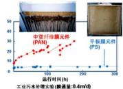
● 由于更有效的曝气和低跨膜压差,它比中空纤维膜元件消耗能源更少。
