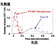
★ 无数个微细小孔平均分布在整个膜性的表面,它确保畅通的 高品质出水和良好的渗透性。
